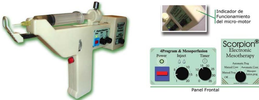
En el panel Frontal se encuentra el comando de dosificación **“Inject”** para seleccionar la cantidad de microgotas a aplicar. Esta función nos permitirá limitar la cantidad de medicamento inyectado por punción y de esta manera evitar la pérdida de medicamento.
